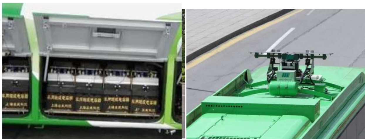
Сурет 2.1 – Ultracap bus – суперконденсатордан тұратын электрлік автобус. Қытай мен АҚШ елдерінің бірлескен жобасы Sinautec Shanghai Aowei Technology Foton America Bus “Comparison of SC and high-power batteries for use in hybrid vehicles”, M.
